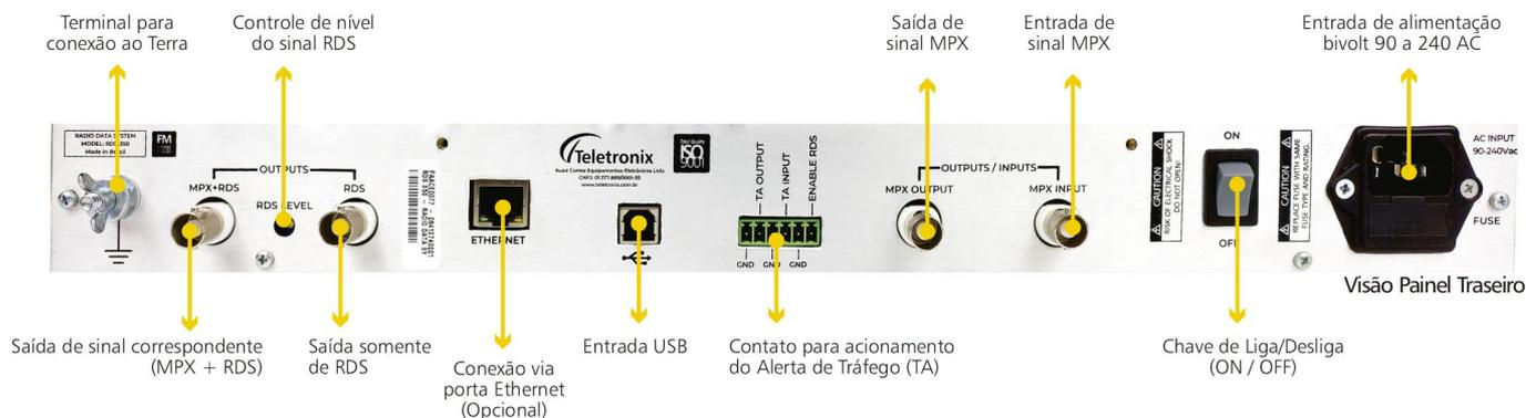
Equipamento concebido em forma de rack 19 polegadas, bivolt que possui porta USB e porta Ethernet para comunicação com o computador, interface gráfica onde configuramos os seguintes parâmetros do sistema RDS:
